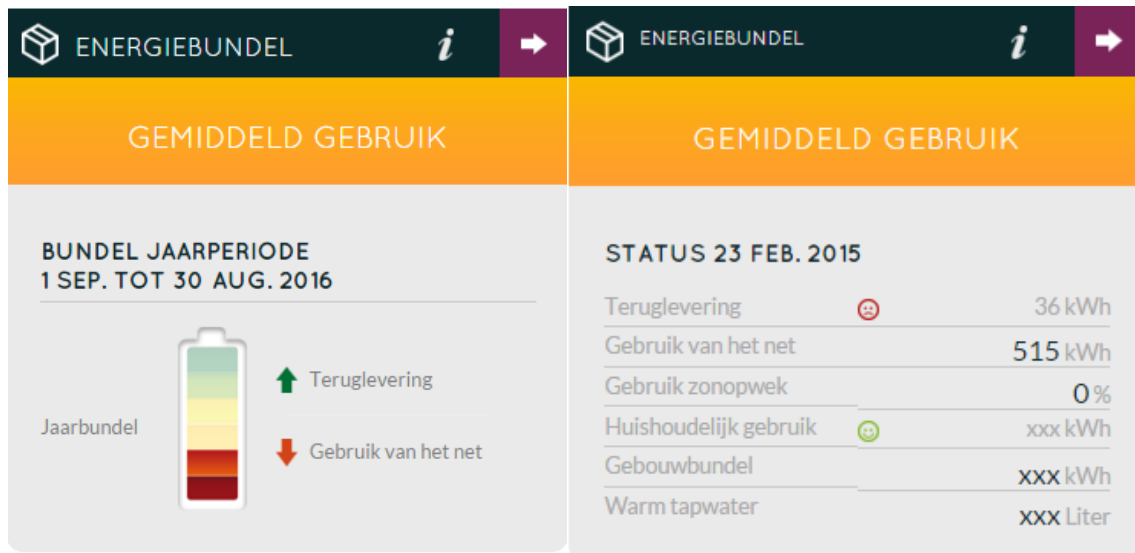
Figuur 7: Energiebundel en detailinformatie
